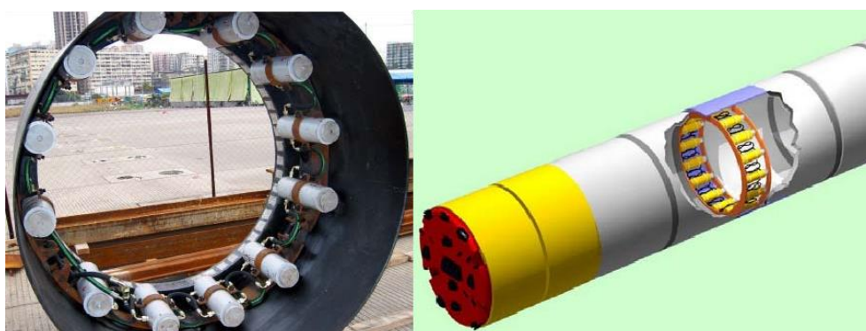
Figura 6 -Descrizione del metodo – Immagine di una stazione intermedia di spinta (da Herrenknecht website)
